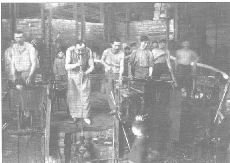
**Fig. 4** - Les équipes de verriers devant les fours, vers 1930 : au fond, les fours ; à l'arrière-plan, les « gamins » ; au premier plan, à gauche, le « grand garçon », puis le souffleur, puis le porteur (coll. particulière).
